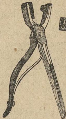
Рис. 145. Щипцы для насечек со вставною режущою частью.
